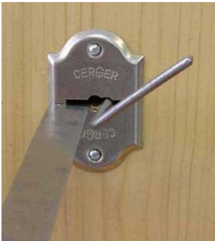
Фото 2. На фотографии зафиксирован процесс снятия слепка с ключа. В данном эксперименте вы видите замок CERBER. Именно на нем специализировались пойманные воры. Манипулируя правой рукой с шилом
