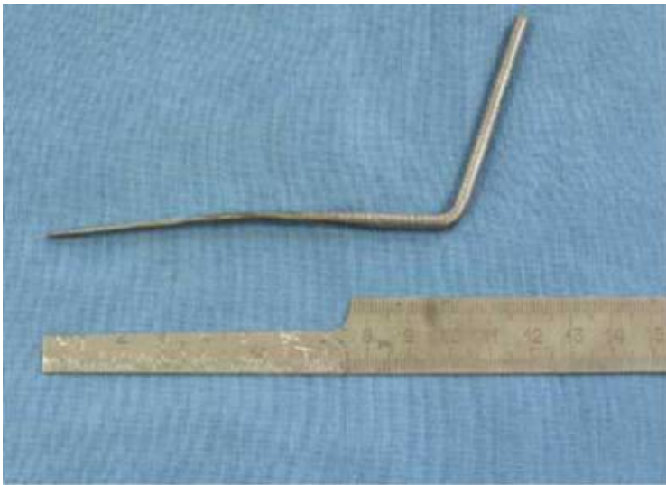
Фото 1. Инструмент, при помощи которого можно изготовить слепок с ключа, оставленного в замке со внутренней стороны двери.
