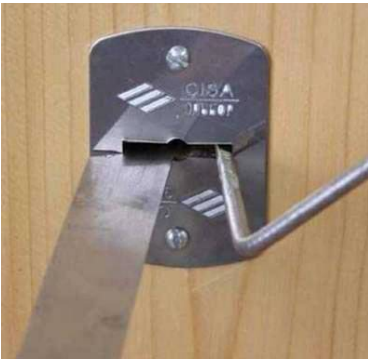
Фото 10. На фотографии вы видите процесс снятия слепка с замка Cisa-Эльбор.
